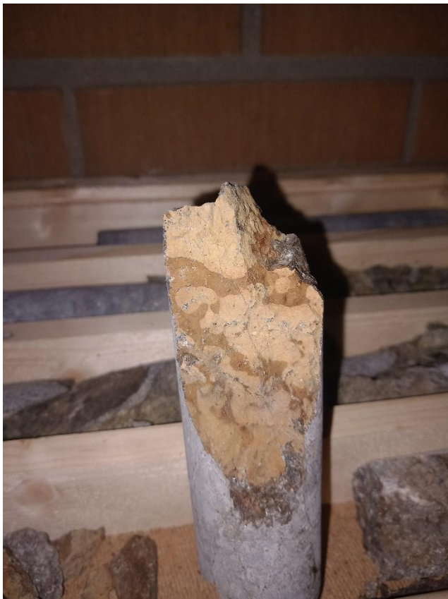
Bild 11: Tydligt oxiderad kärna.
